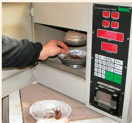
**Foto 3 - Bilancia a infrarossi impiegata per la determinazione del contenuto idrico del cippato di vite**
