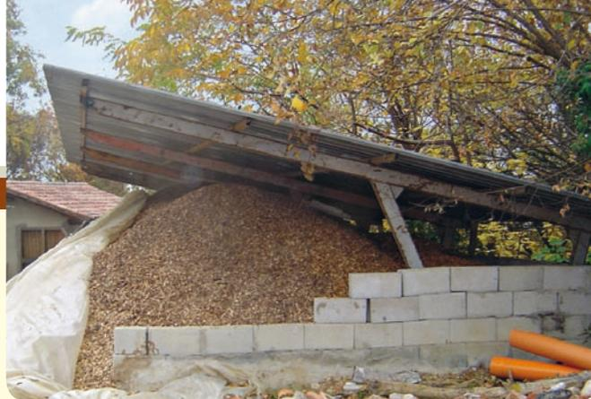
**Foto B** - La stagionatura del cippato sotto una copertura dura circa 4-5 mesi
