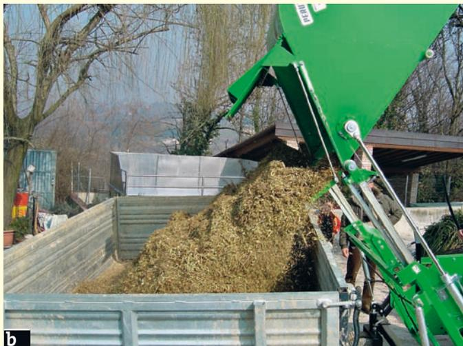
Foto A - La raccogli-trinciatrice Cobra Collina della Peruzzo raccoglie 1 ha/ora, cioè circa 2 t/ora di sostanza fresca. Raccolta (a) e scarico (b) del cippato
