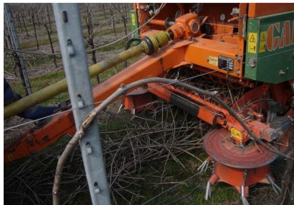
**Foto 1 Particolari del raccogliitore per la raccolta dei sarmenti della rotoimballatrice a camera di compressione a volume fisso studiata**
